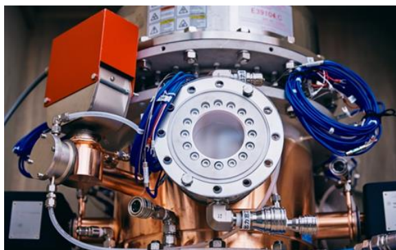
【プラズマ加熱装置：ジャイロトロン】
