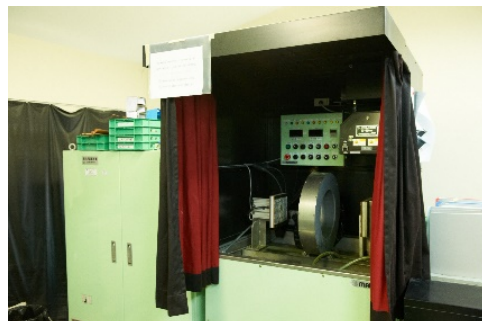
同社導入の磁粉探傷設備
