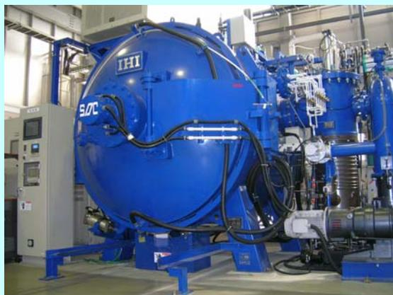
写真：SDCプラズマ表面硬化処理装置
