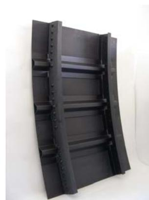
写真：航空機ドアモデル
