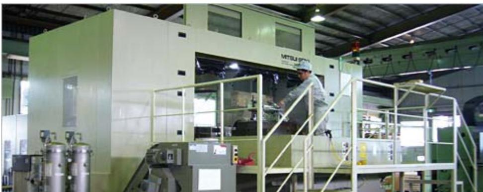
写真: 大型の機械も充実 □1,000mm トラニオンタイプ同時 5 軸横型 MC (同社ホームページより)
