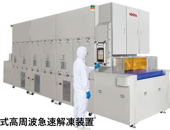
厚みのある冷凍原料でも、中心部まで均一な急速解凍を実現
