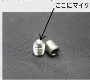
セットスクリューの先端真ん中にマイクロホール加工
