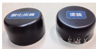
絞っても剥がれない酸化皮膜（塗装と比較）
