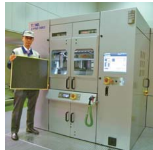
樹脂流動レス圧縮成形による大判化の可能性を求めた次世代超大判圧縮成形機CPM1180と成形品(パネルサイズ660X515)
