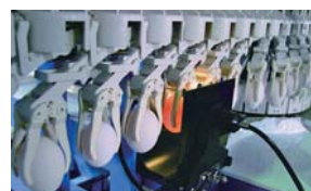
異常卵検査装置 (赤外分光により不良(異常)卵を検出する装置)
