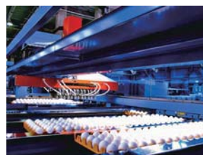
鶏卵選別包装装置 (卵を選別してパックに包装する装置)
