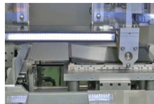
タッチパネル付カバーガラスと液晶モジュールを貼付ける様子
