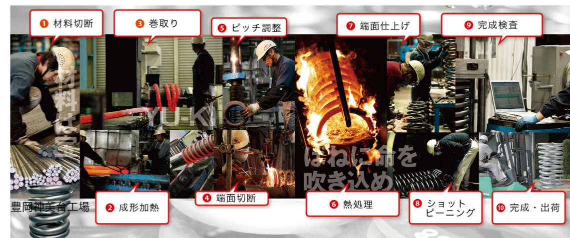
手づくりばねの製造プロセス
