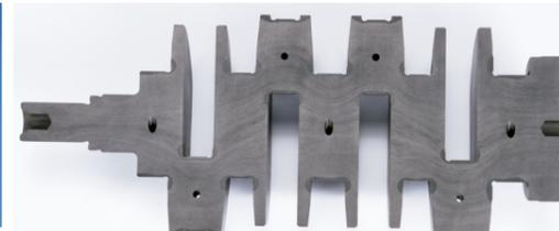
半分に切断したクランクシャフト（=エンジン内の車軸を回すための回転軸）でみる焼入パターン。変色した部分が焼入技術による硬化層
