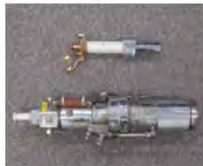
水冷トーチ比較（上が銅合金3D 積層造形の水冷トーチで、重さは600g、下は従来品で重さは9000g）。
