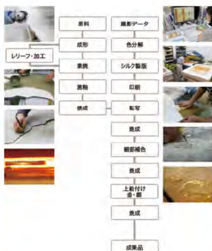
陶板によるキトラ古墳壁画の製造フローチャート
