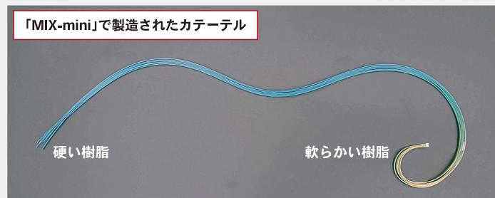
太さを変えずに材質だけで硬さを変更しているカテーテル
