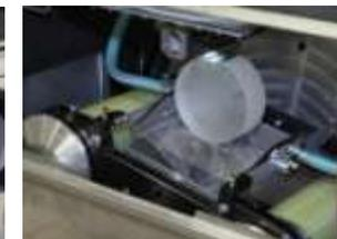
マルチワイヤーソーによるサファイアのスライス加工の様子
