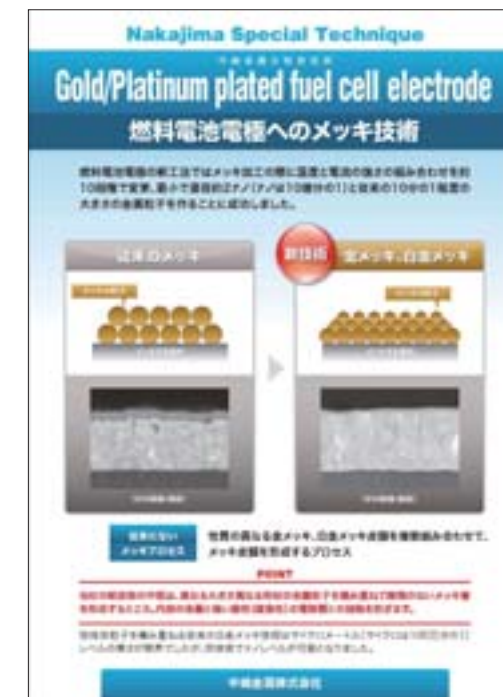
「世界初」! 新規めっき技術のメカニズム
