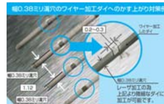
かす上がり 対策を施した 焼結ダイヤモンド (PCD)金型ダイ
