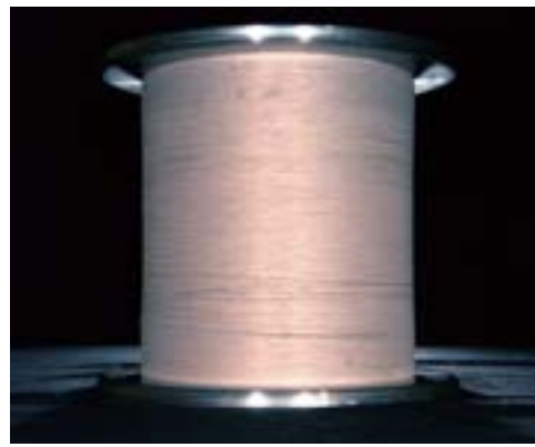
加工装置用ポビンに巻かれたダイヤモンドソーワイヤ
