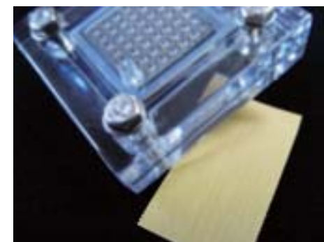
新規めっき技術を用いた燃料電池電極
