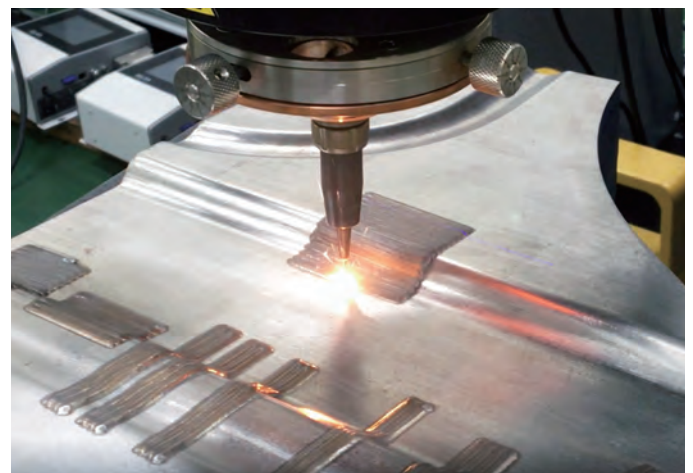
インラインモニタリング機能により高精度な肉盛溶接加工を実現
