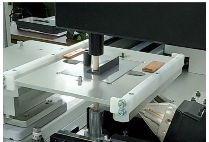
ALTIMでは高い接合強度と耐久性・機密性が得られる。写真は加熱圧着ユニット
