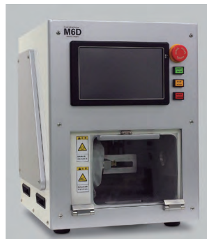
開発した卓上型4軸加工機(左)と製作した歯科用補綴物の例(右)
