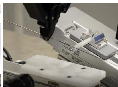
極細ファイバースコープを小径パイプへ自動挿入する様子
