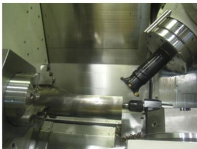
▲多刃工具による高効率加工実施例
