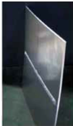
▲摩擦攪拌接合 (FSW) 突合せ接合のテストピース
