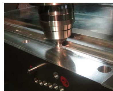
▲リブと外板の突合せ接合試験状況
