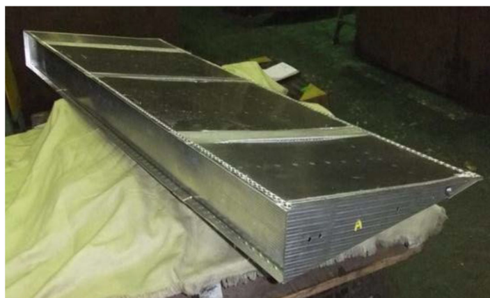
▲摩擦攪拌接合で組み立てた航空機のエルロン
