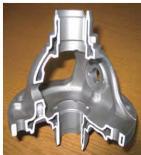
▲世界初の鑄造技術「密閉中空鑄鉄」
