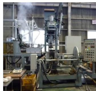
▲過熱水蒸気供給装置を搭載した鑄型造型機
