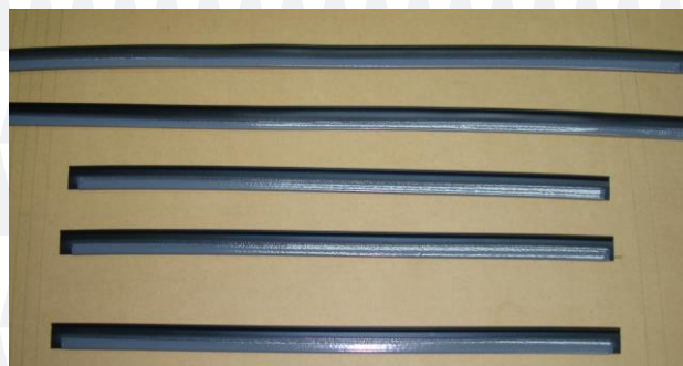
▲エレベータ気密ゴム
