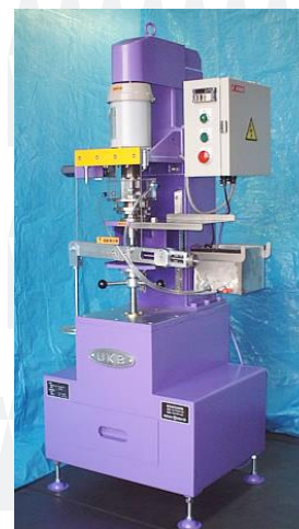
▲新規開発・製作した転がり疲労試験機は、転がり疲労やき裂等のウェット試験も可能
