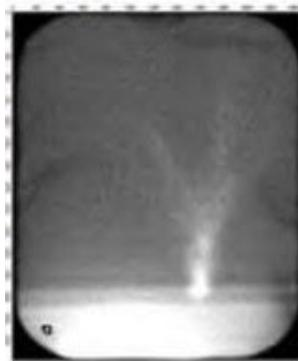
▲2cm角のSUS板に人工的に作った亀裂のX線投影データ
