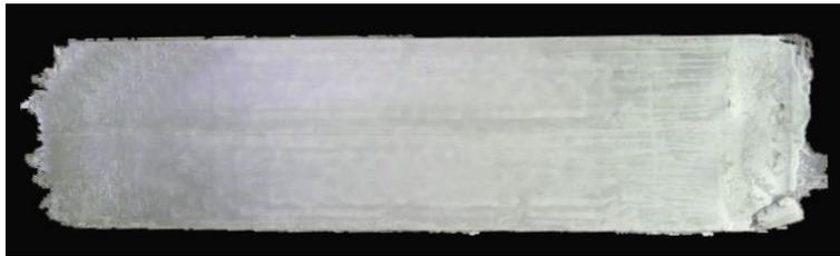
▲異径双ロール鋳造機によって作製した 400mm 幅 Al-40%Sn 合金板
