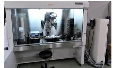
細胞継代培養自動化システム
