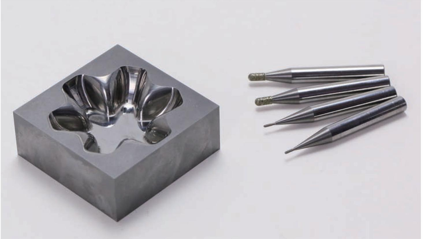
製品・技術の名称 **超硬合金金型の直彫り磨きレス加工用
