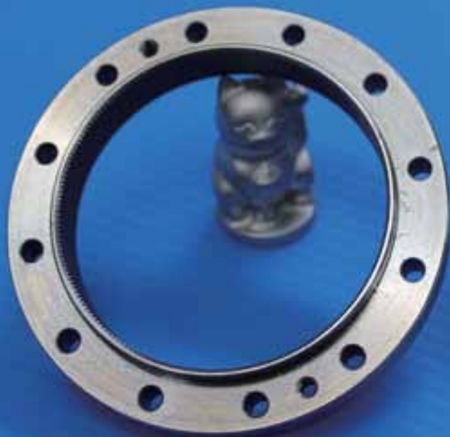
シナジー効果ハイブリッド低温表面処理技術 JAXA 宇宙用ステンレス鋼波動歯車の共同研究
