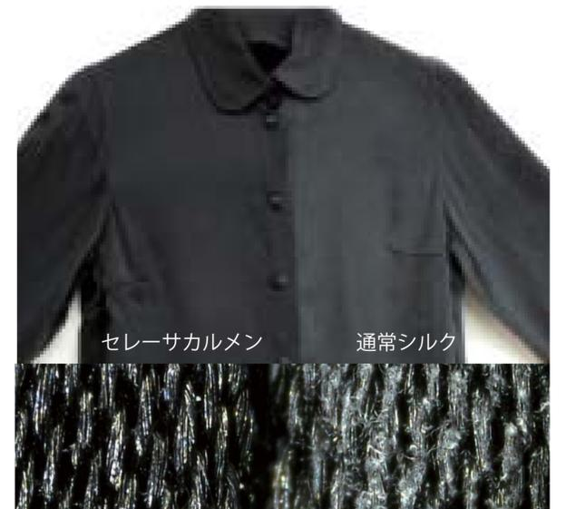
電子顕微鏡写真での比較
