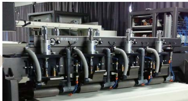
超音波パンチング加工機（特許技術）
