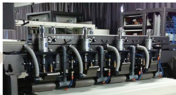
超音波パンチング加工機（特許技術）
