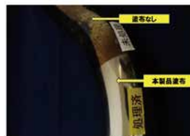
写真 マフラーでの処理と未処理比較
