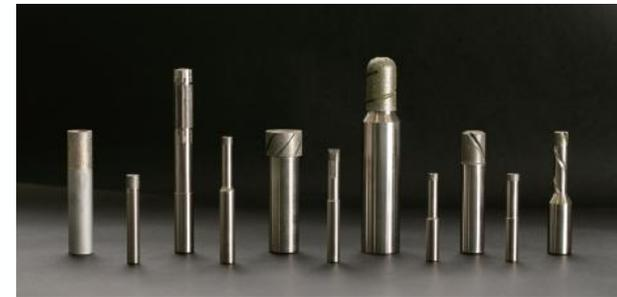
超合金金型の直彫り磨きレスを可能とした高精度ボール形状のダイヤモンド電着工具です。従来の製法は放電加工→熟練工の磨き作業という流れでしたが、本製品を使用することにより、最後の「磨き工程」までマシニングセンターにて全て機械的に加工でき、品質の安定化、加工時間短縮が可能です。
