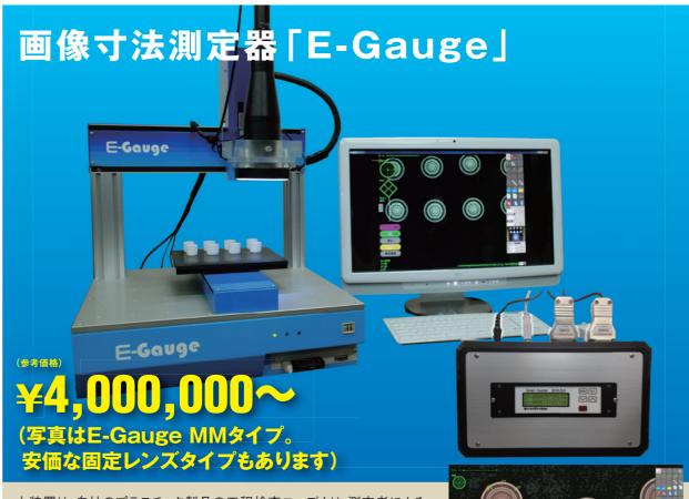
本装置は、自社のプラスチック製品の工程検査ニーズより、測定者による 測定ばらつきを抑制し、誰もが早く、簡単に製品の寸法測定が出来る装置 として開発したものです。独自技術により高額な大型レンズを使用すること なく高精度寸法測定ができる、コストパフォーマンスに優れた装置です。レ ンズの視野(32×24mm)に納まる小さな製品はもちろん、視野に入らない 大きな製品(最大150mm×144mm)でも、解像度の高いレンズを使い独 自の画像連結技術で画像を取り込むことで、高精度(±15/1000mm)で 寸法測定をすることができます。また、簡単に設定でき、1クリックで自動測 定できる機能もあり、現場でも簡単に使える仕様となっています。
