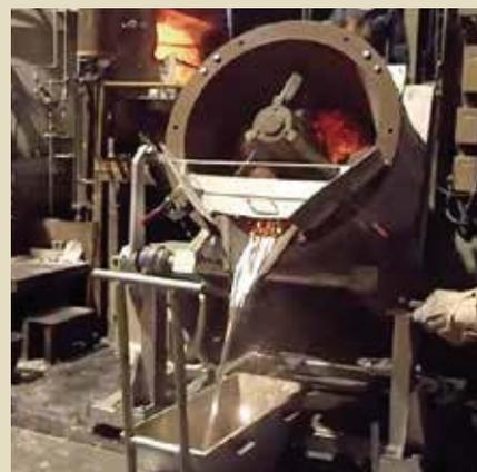
『小型アルミドロス処理回収装置』は、アルミ合金加工業界、特にダイカスト業界から要望のある、溶解処理能力が2t/h以下に対応できるものです。この装置は、工場内スペースに制限のある、ダイカスト工場でも対応できるまで小型化し、長年解決できなかった、3つの課題、(1)作業に必要な熟練技術の効率化、(2)作業の安全性の向上、(3)装置の耐久性向上、を、予熱ヒーターシステム、リモコン操作、オリジナル特殊形状釜によって実現させました。
