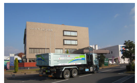
コンテナ車で温浴施設まで熱を運搬
