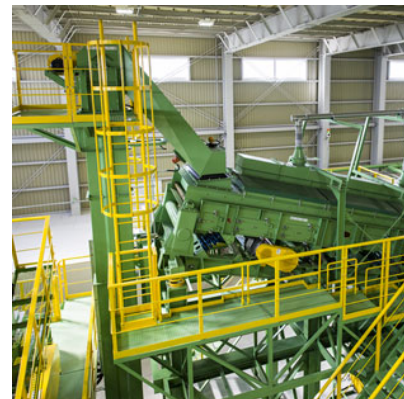
独自の技術により、含水量が多い端材や付着性が高い端材でも連続して解砕できる特殊振動ふるい機。
