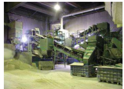
同社が所有する ALC 端材専用の破碎機。室内には専用の集じん機を装備している。
