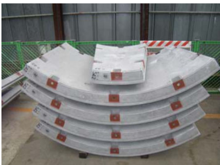
再生 PET 繊維を混入したコンクリート製のセグメント
