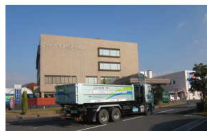
コンテナ車で温浴施設まで熱を運搬
