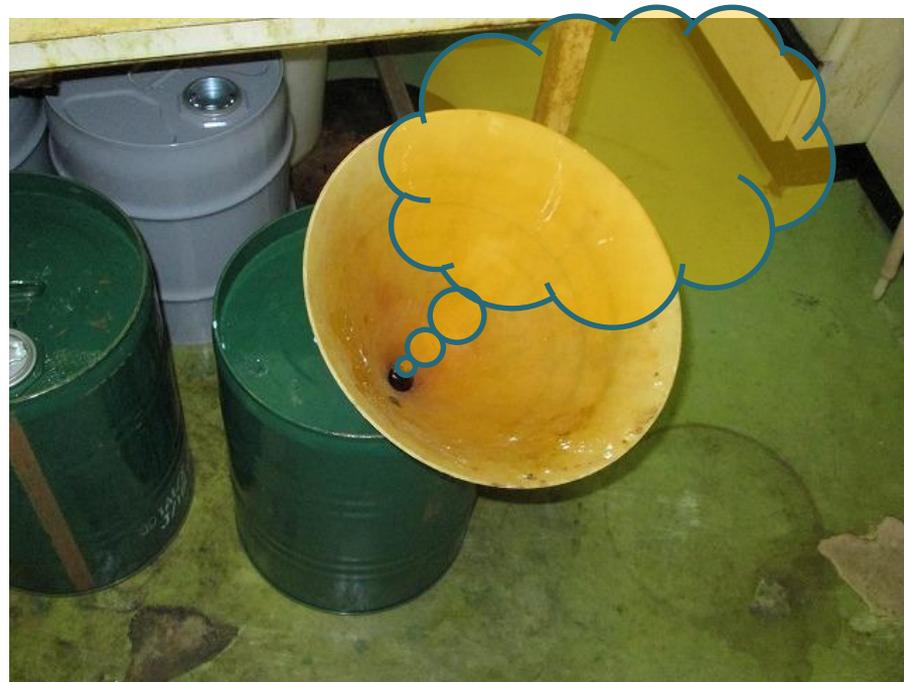
使用済みウエスや廃液を入れる容器は蓋をするなどして密封しないと、有機溶剤の蒸気が作業場内に発散し、作業環境を悪化させます。
