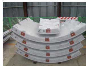
再生 PET 繊維を混入したコンクリート製のセグメント
