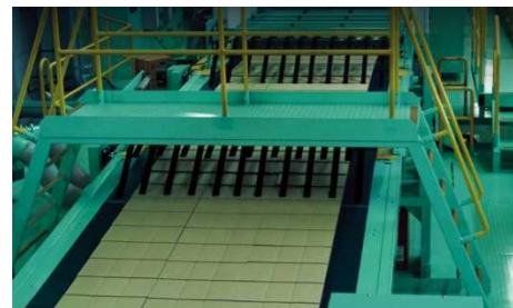
段ボールシートを作るコルゲートマシンは、最新鋭の設備を導入している。
