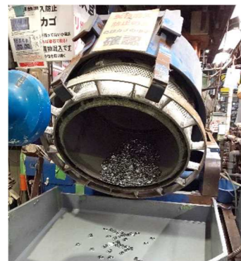
製品が多数入った樽をめっき液に浸漬させるバレルめっき法(左)と、1つずつフックにぶら下げて行う静止めめっき法(右)の2つの方法で、亜鉛めっきを施している。
