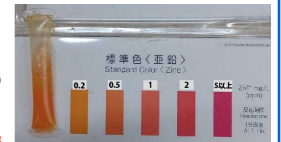
亜鉛の排水処理状況をバックテストで簡易検査している様子。標準色との比較で0.5mg/L前後であることを確認している。
