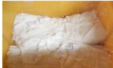
タオルに酵素を付けて、廃熱を利用し45℃程度に高めた室内で一晩寝かせて糊を分解させる(フロー図②)
