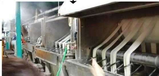
タオル生地を水洗いして糊や汚れを落とす水洗槽は5つあり、水洗槽の水は再利用している(フロー図③)
