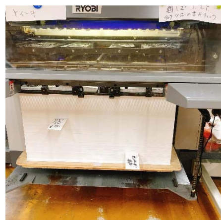
LED(青色光)で照射し、インキを乾燥する様子。
