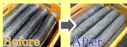
トリクロロエチレン洗浄を行った金属部品の例。黒ずみが取れて、元の金属の色に戻っている。
