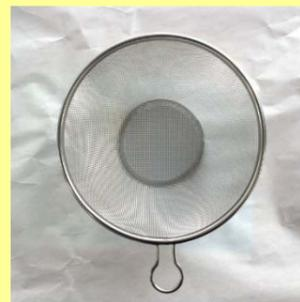
炭化水素洗浄を行った調理用のザル。同社では細かい網目も炭化水素洗浄で綺麗に洗浄できるノウハウを有する。
