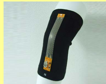
同社で製造しているフレキシブルプリント回路基板(FPC)の一例。 左は医療機器や携帯電子機器等で使用される極薄多層 FPC、 右はウェアラブル電子機器、介護補助機器等で使用される高伸長 FPC。
