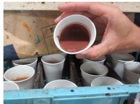
着色した捺染糊のサンプル。ターペンが約 50%を占めており、粘度が高い。
