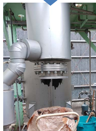
廃捺染糊から固形分が分離される様子。円筒の内側に固形分をへらで塗布することで、ターペンと固形分に分離している。
