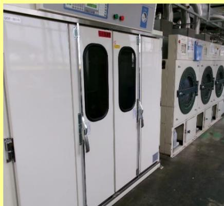
溶剤回収できる乾燥機。左がハンガー式、右の3台がタンブラー式。
