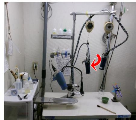
染み抜きで使用するエタノールは、染み抜き場所などに吸引機(矢印箇所)を当てて吸い込んでいる。
