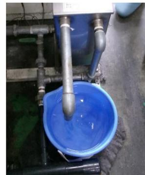
乾燥時に揮発した溶剤ガスを、冷却装置(写真左・黒い箱)で冷却・液化させた後、溶剤として回収。1日2回、溶剤をバケツ(写真右)で回収する。
