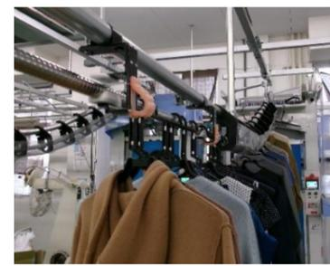
ハンガーは、プラスチック使用量を極力減らした薄型を採用している。
