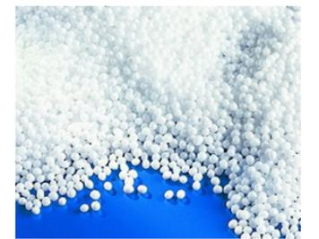
エペラン®の樹脂ビーズ。発泡剤によりビーズを発泡させた後、それぞれの用途の製品に成形。強度や弾力性、耐熱性、耐薬品性、寸法精度に優れている。
