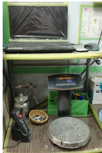
色の調合場所。 機器の測定結果が PC に送信され、結果を元に調合。車体へ塗布して比較する。その後、車体への塗布と機器分析を 3 回ほど繰り返し、色を近づけていく。
