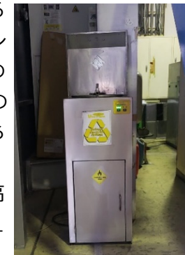
左：シンナーが再利用できる装置。右：装置で抽出した再生シンナーは、新品のものとほとんど変わらない。
