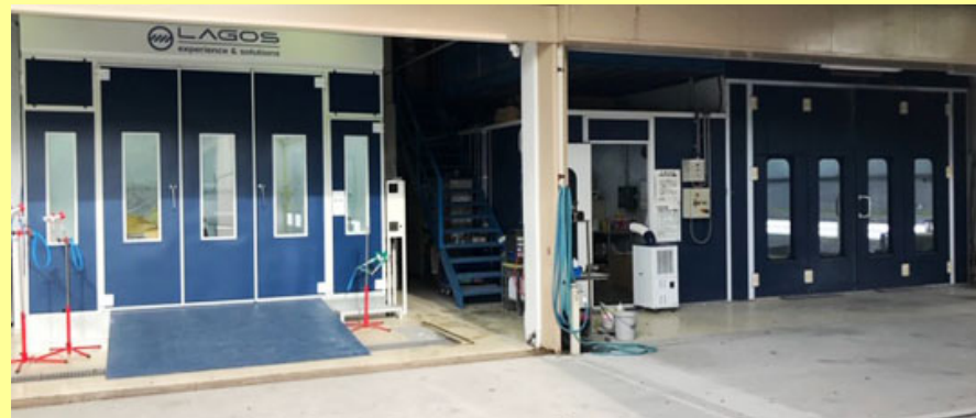
塗装ブース 2 台を所有。左が日本製の上げ底型、右がイタリア製の掘り込み型。
