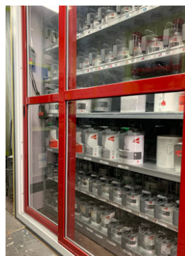
塗料の保管庫。塗料を 10～15℃に保ち、保管している。
