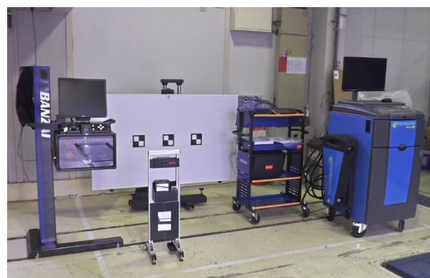
ヘッドライトの明るさ・照射方向を調整する「ヘッドライトテスト」(左)と、車体に対するホイールの取付角度を測定し、まっすぐ走ることができるよう調整する「アライメント」(右)。ともに高額な装置のため、保有する自動車钣金塗装工場は少ない。
