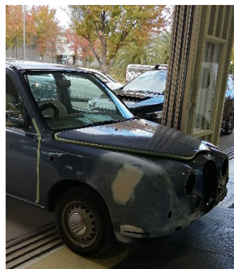
塗装前の車体。 塗装する箇所の色をはがした形で塗装作業に入る。
