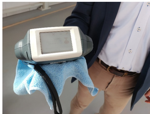
車体の色合いを測定する機器。液晶面を車体に当てて、色の割合を 0.1g 単位で分析する。
