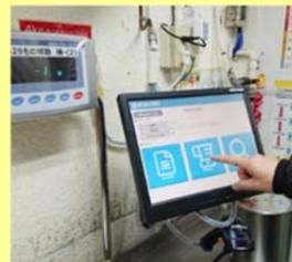
塗料ポットに投入した主剤量に合わせてシンナーや硬化剤の最適量を自動計算。電子秤と連携したミスのない塗料調合が可能。
