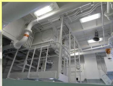
船舶用水性塗料「ALQUA SHIP」で塗装した船体内部の例
