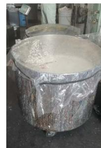
各材料を入れている槽から製品を混ぜる一斗缶へ必要な量だけ直接投入する「モジュール生産システム」を採用。材料の廃棄率削減につながることで VOC 削減効果もある。
