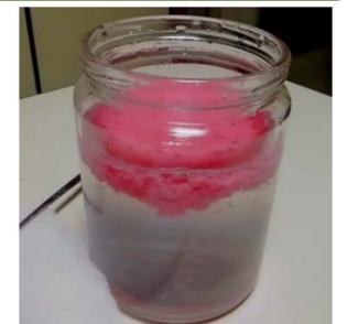
塗料廃液に処理剤を混ぜると上澄みの固形と液体に分離され、それぞれプラスチック廃材とpH調整のみで下水処理できる廃液として処理。従来の処理方法よりも簡略化できる。
