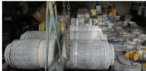
装置や設備の洗浄等で使用した後の有機溶剤。密閉し、3カ月に1回の頻度で産業廃棄物として業者が回収する。
