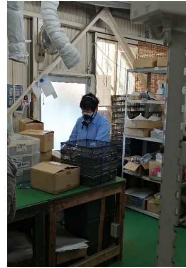
トリクロロエチレン使用の洗浄設備に材料を設置・回収する担当者は防毒マスクをつけている。
