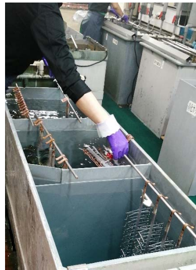
手作業でラックめっきを行う様子。浸ける時間で色味が変わるため、顧客の好みに沿うよう、めっき液に浸ける時間を変える。
