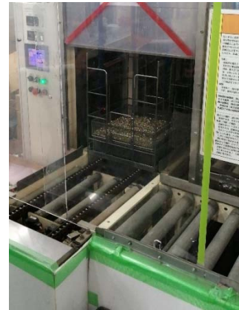
洗浄工程を終え、設備から引き上げられているめっき材料
