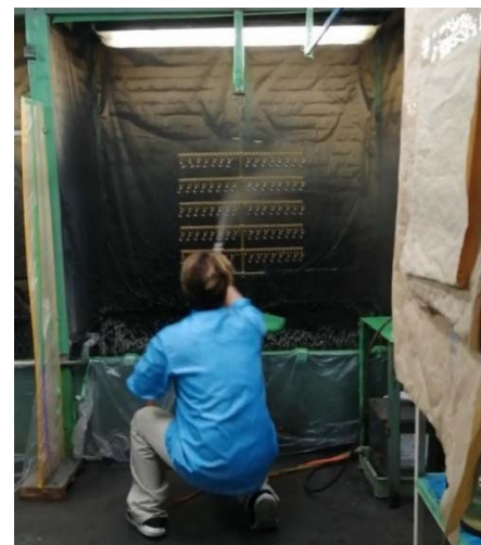
塗装加工（トップコート）の様子。無色透明の塗装で、めっきのツヤ感が向上し、耐候性や耐摩耗性が向上する。
